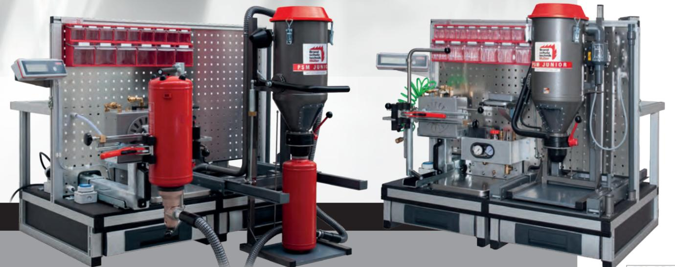
• Löschpulverumfüllung mit dem integrierten Entleersystem FES. • Mobile Feuerlöscher-Serviceeinheit MFS mit Zubehör.
