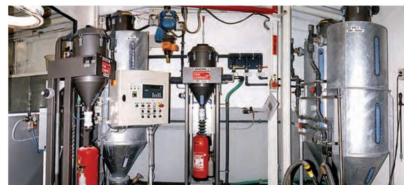
• Kundenspezifische Löschpulver-Füllanlage mit zwei Abfüllständen.
