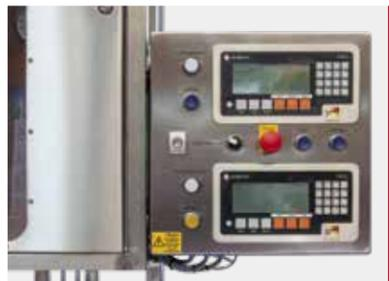
Die wesentlichen Bauteile der Anlage bestehen aus Edelstahl. Eine integrierte Wägeplattform ermöglicht die rezeptgenaue Befüllung der Feuerlöscher mit flüssigen Löschmitteln bis zu einer Behälterhöhe von 620 mm und einem Gesamtgewicht von maximal 30 kg.
