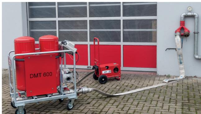
• Durchflussmessgerät DMT 600 im Einsatz.
